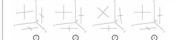
16. На каком чертеже правильно вычерчено направление большой и малой осей эллипса – прямоугольной изометрии окружности, расположенной в координатной плоскости  $xy$ ?
